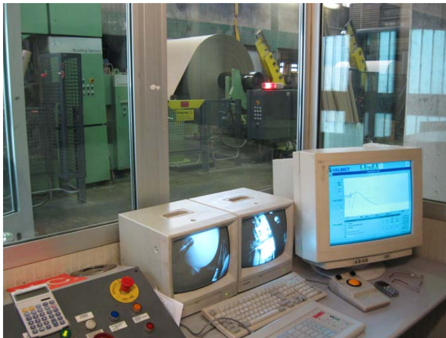
Veduta della sala di controllo ribobinatrice VALMET, Smurfit Kappa Ania.
