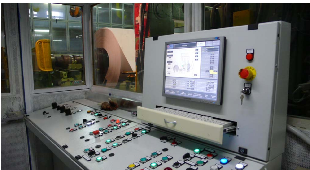
Pulpito di comando della ribobinatrice da 7 metri di formato utile; velocità di crociera 1800 metri/1
