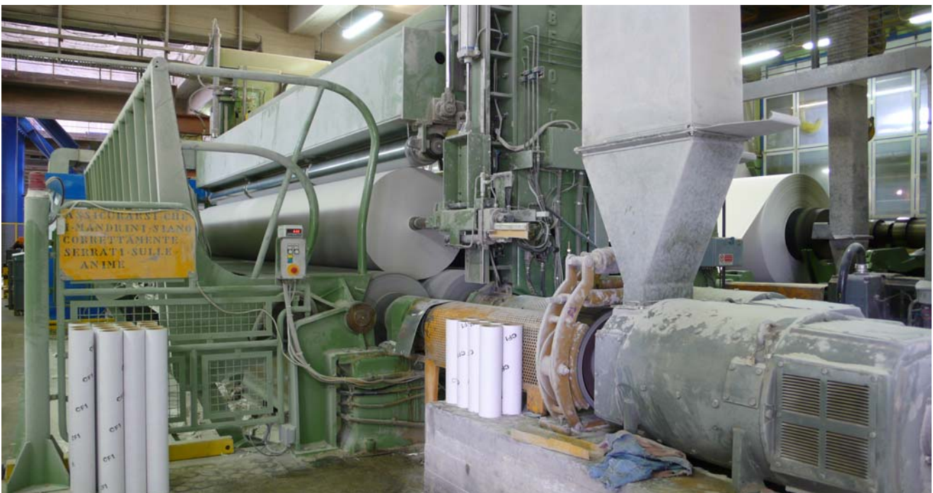
Tamburi portanti della ribobinatrice BELOIT, cartiera di Mantova, dic. 2007
