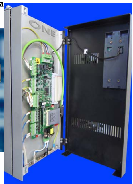
L'unica scheda di regolazione uguale per tutti i nostri convertitori DC-AC-BRUSHLESS-CHOPPER e REBORN (sistema che recupera tutti i drive DC di qualsiasi modello) della serie "PLATFORM ONE DRIVES".
