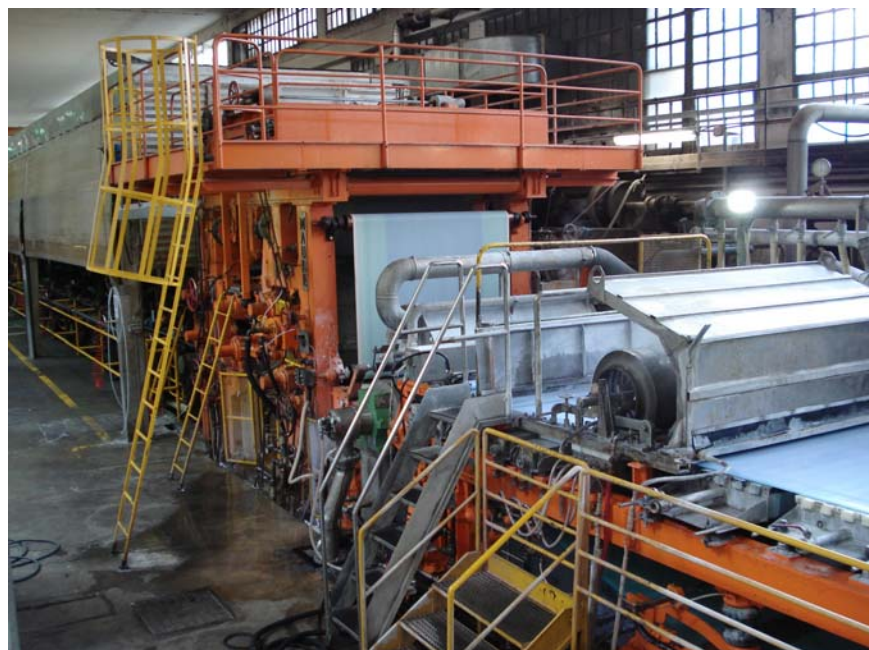
CARTIERA CORDENONS 2010, conversione di PM1 in comando sezionale
