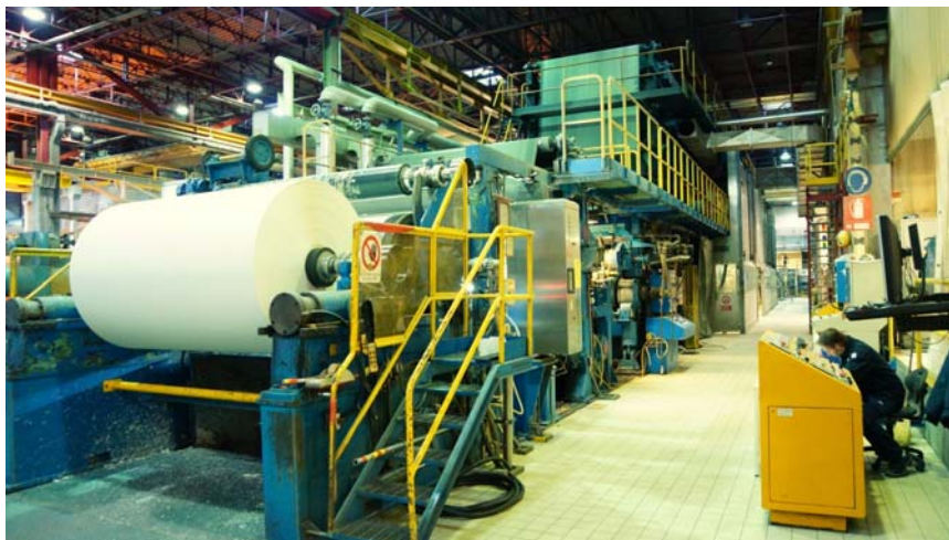
Zona Pope MC3 ricostruita in due step con “PLATFORM ONE”, il comando sezionale duttile e flessibile di SAEL, creato per durare nel tempo.
