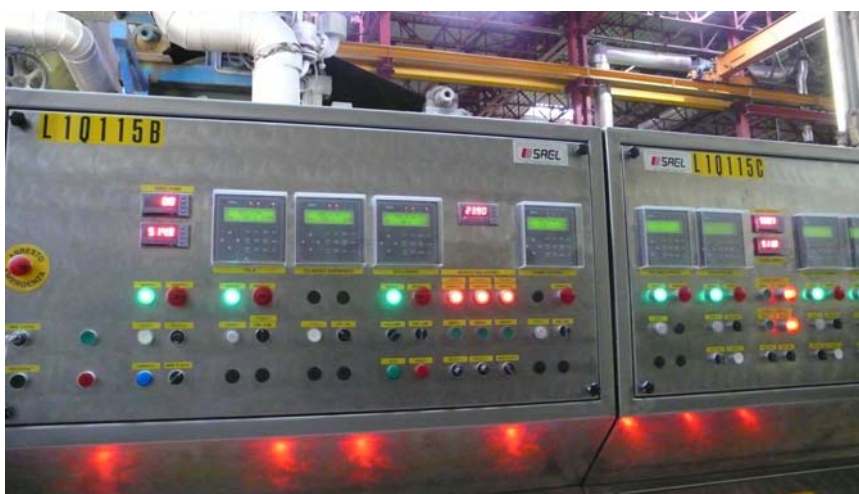
Una sezione dei nuovi quadri forniti per la zona umida MC1 e i pulpiti di comando realizzati dalla cartiera.
