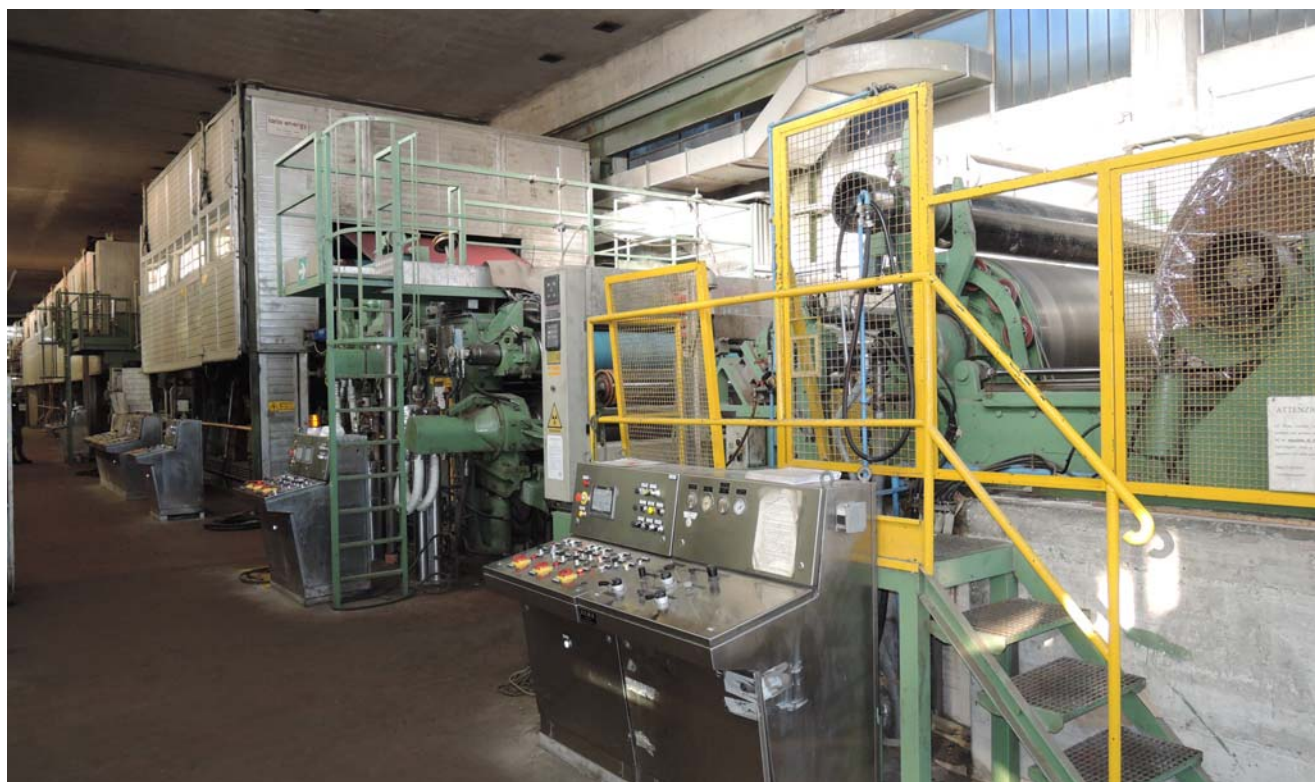
Pope, calandre e secchiere delle cartiere SACI - PM3 equipaggiate con inverter raffreddati a liquido
