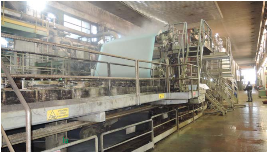
Zona umida di macchina continua, cartiera PM3
