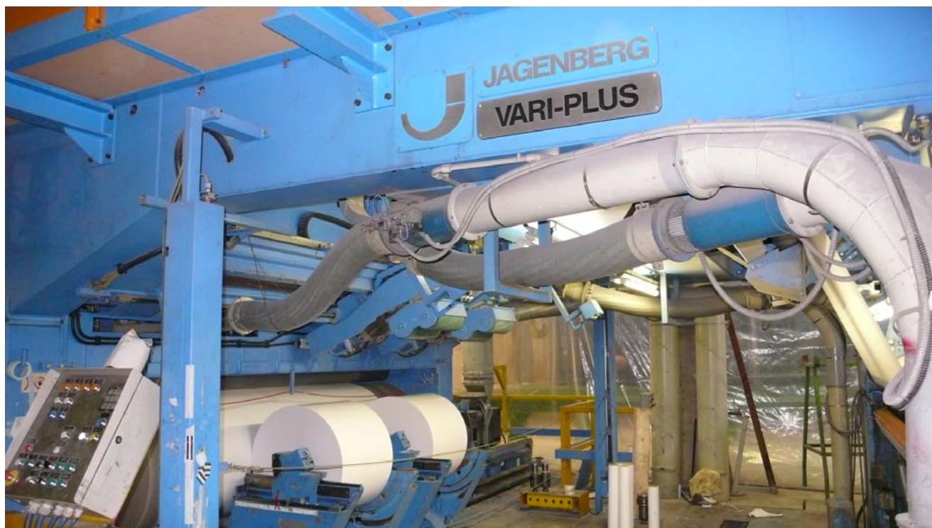
VEDUTA DEL TAMBURO AVVOLGENTE DELLA VARI PLUS, SAEL Intelligent Drive
