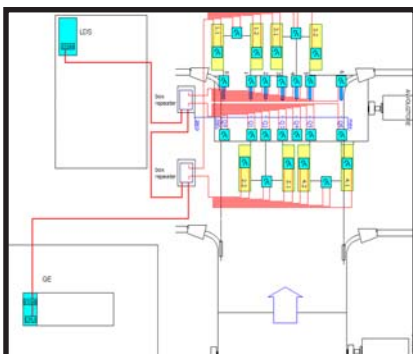
schema rete profibus realizzata
