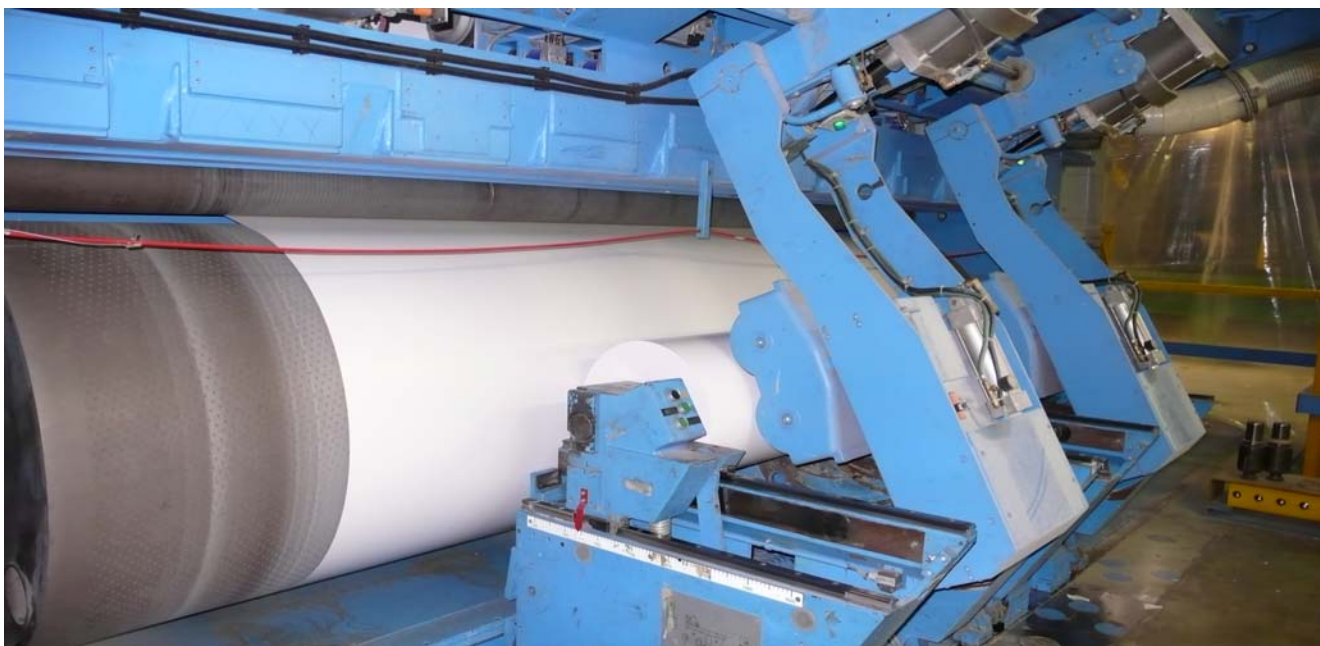
PRESSORI IN FUNZIONE SU CURVA STABILITA TRAMITE LDS SAEL
