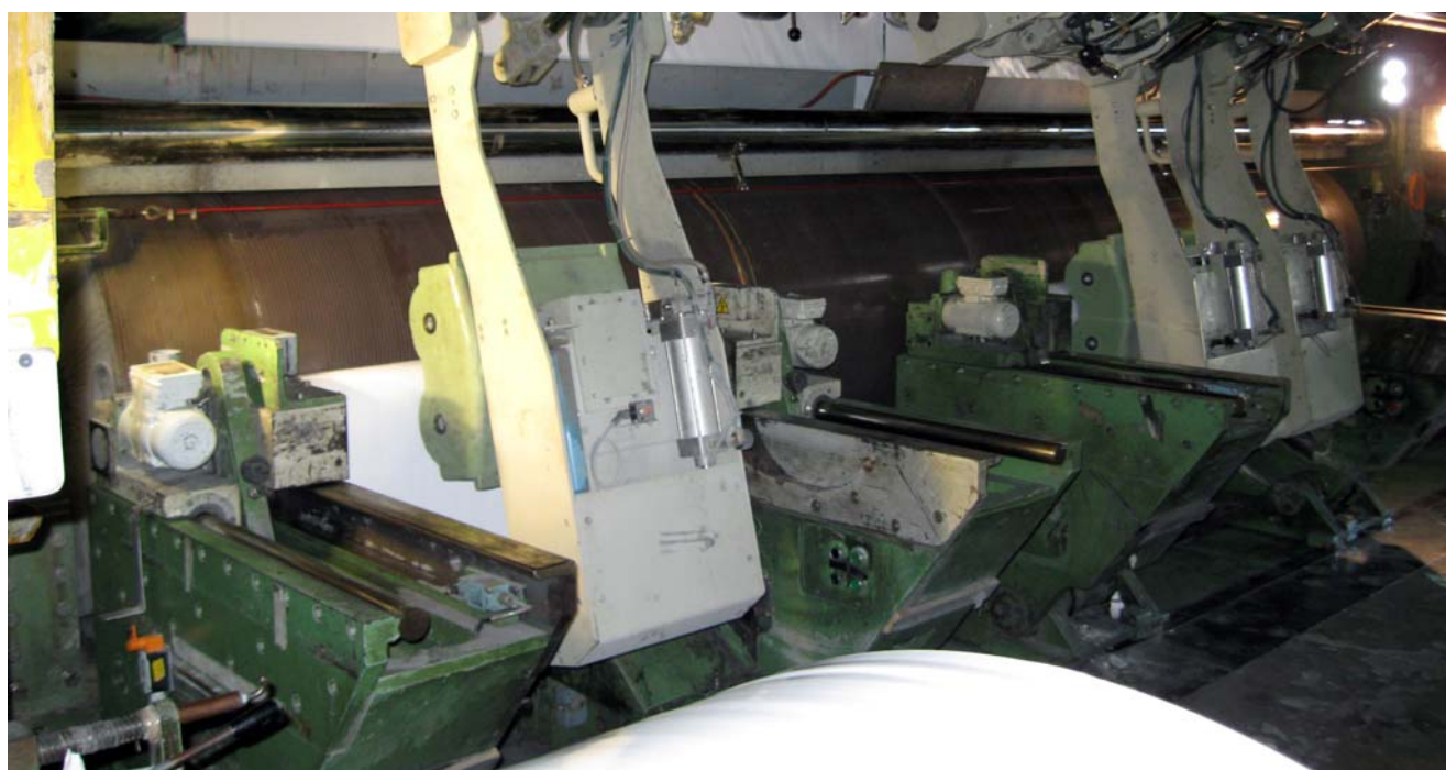
VEDUTA DEL TAMBURO AVVOLGENTE CON PRESSORI INSERITI, SAEL Intelligent Drive
