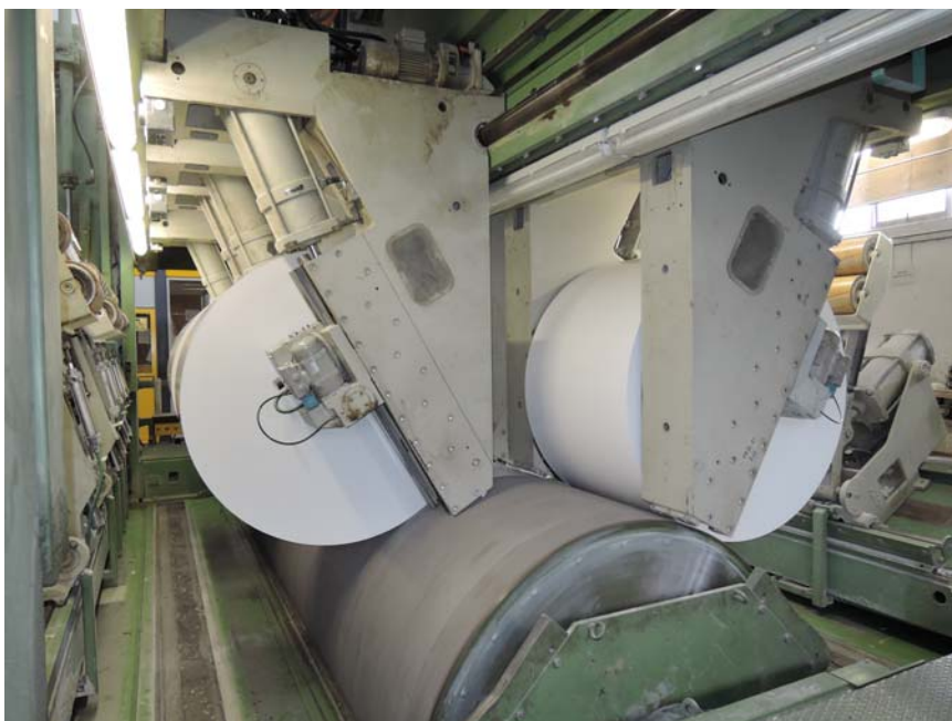
Particolare del tamburo avvolgente della VARITOP
