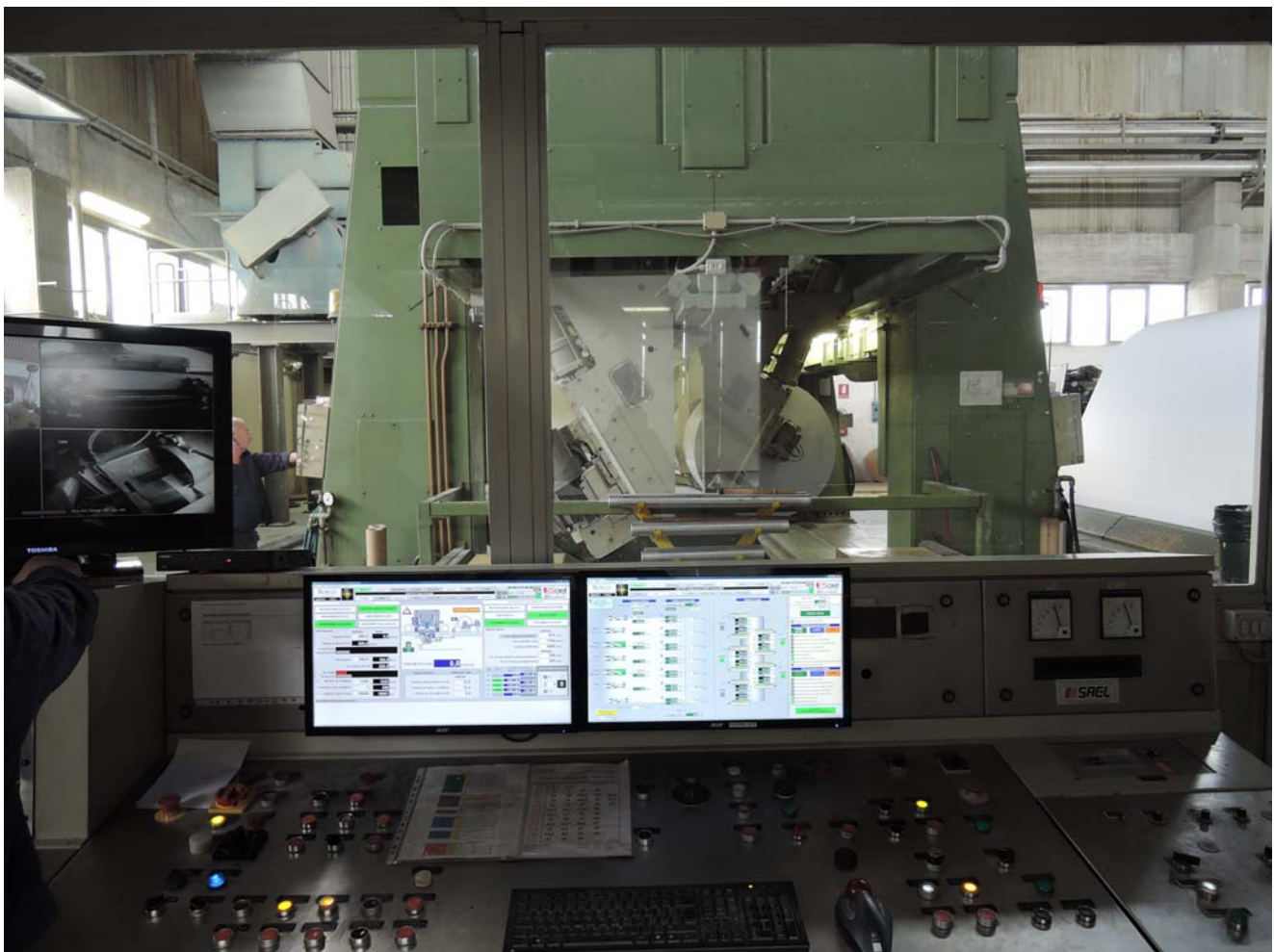
Pulpito di comando della ribobinatrice con DCS "WINDER SAEL" possibile la ridondanza e versione Touch
