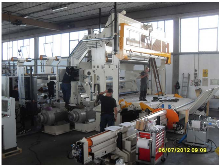
La ribobinatrice durante le fasi di montaggio e test effettuate presso la nostra sede operativa SIMI di Lunata.
