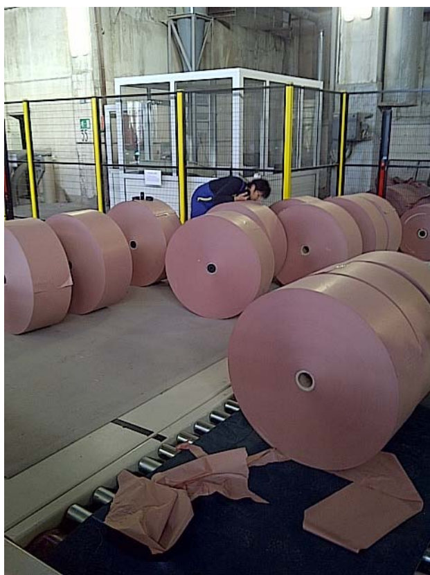
In collaudo dal cliente la prima levata con carta MG da 14 grammi metro quadro.
