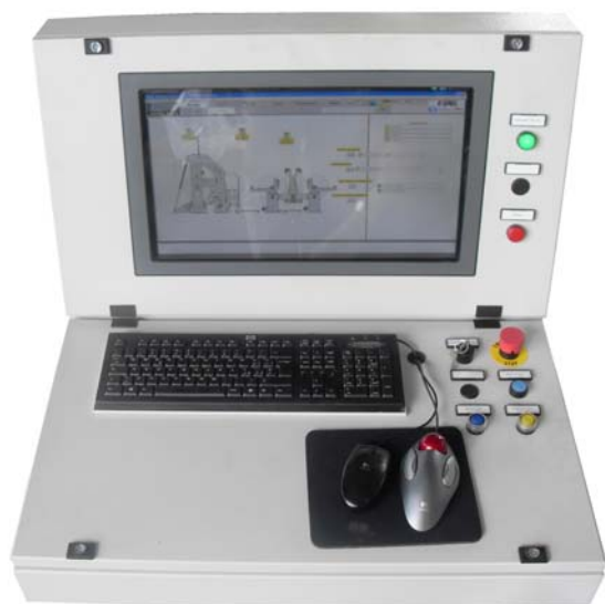
Pulpito di comando principale con il sistema DCS WINDER SAEL
