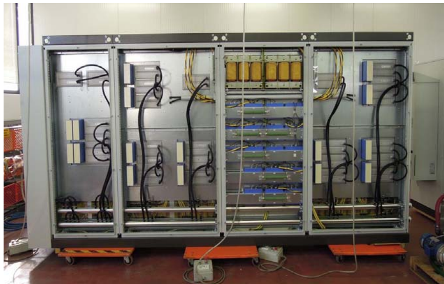
I nuovi INVERTER raffreddati ad acqua, sviluppati per ridurre drasticamente gli ingombri "PLATFORM ONE drives WATER"
