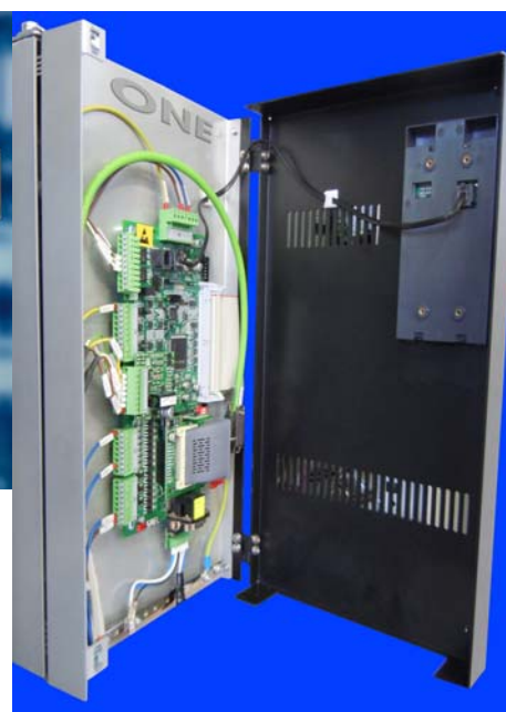
L'unica scheda di regolazione uguale per tutti i nostri convertitori DC-AC-BRUSHLESS-CHOPPER e REBORN (sistema che recupera tutti i drive DC di qualsiasi modello) della serie "PLATFORM ONE DRIVES".
