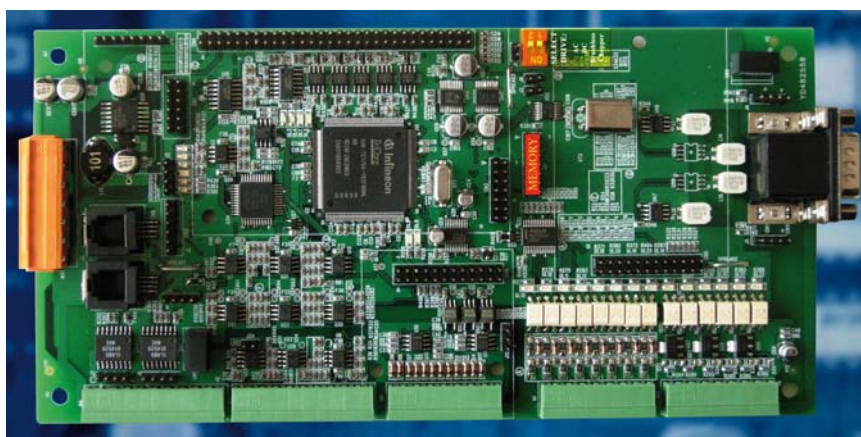
L'unica scheda di regolazione uguale per tutti i nostri convertitori DC-AC-BRUSHLESS-CHOPPER e REBORN (sistema che recupera tutti i drive DC di qualsiasi modello) della serie "PLATFORM ONE DRIVES".
