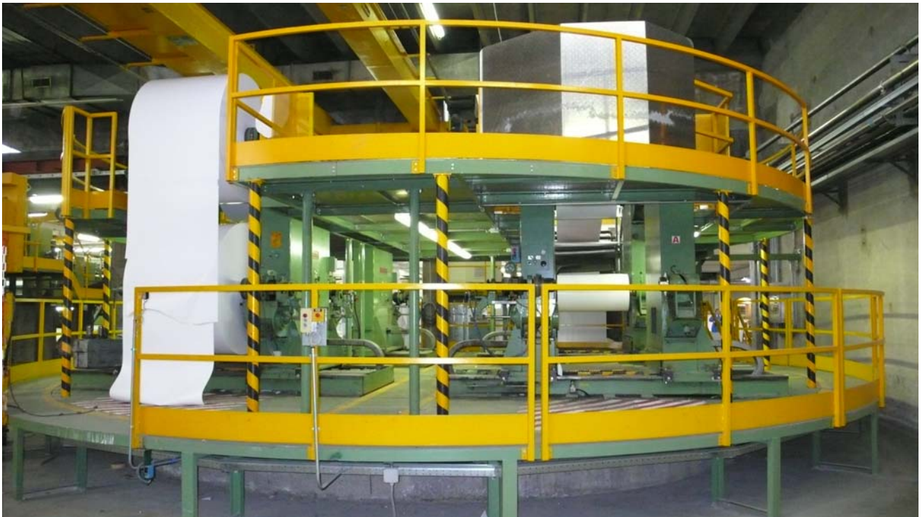
giostra di carico rotoli sulla quale è stata gestita la frenatura degressiva
