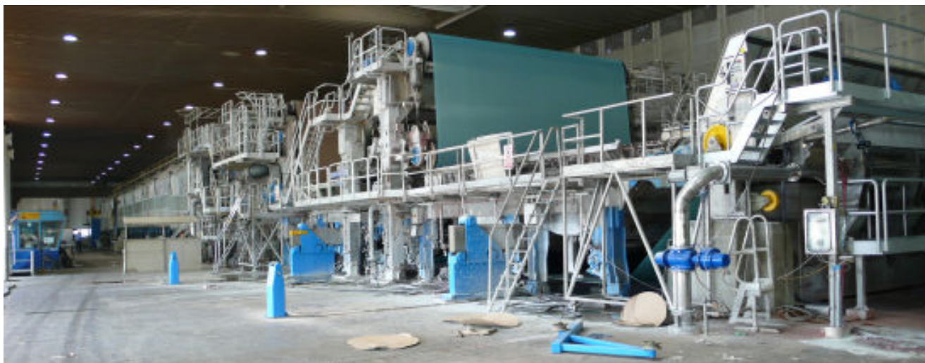
CARTIERA DI MANTOVA, TESTA MACCHINA CONTINUA, SAEL Intelligent Drive
