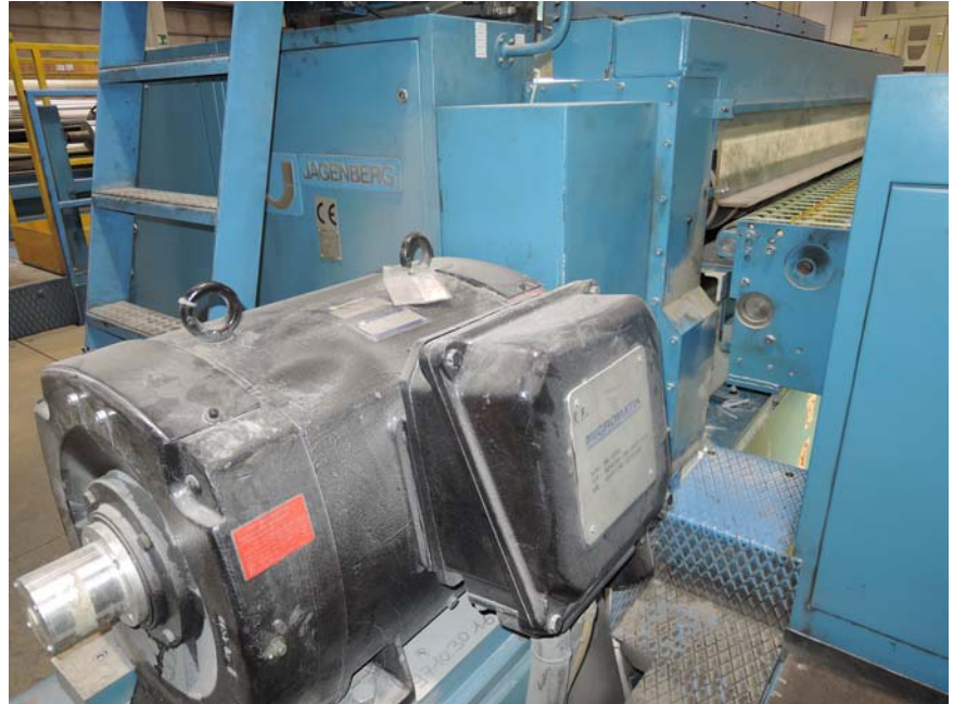
I motori AC Micromatik esistenti comandati dai nostri inverters ONE drive
