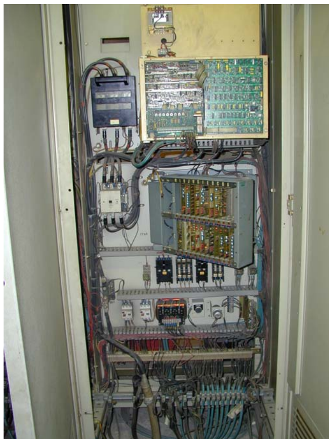
Drive DC esistenti in cartiera prima e dopo la trasformazione con REBORN
