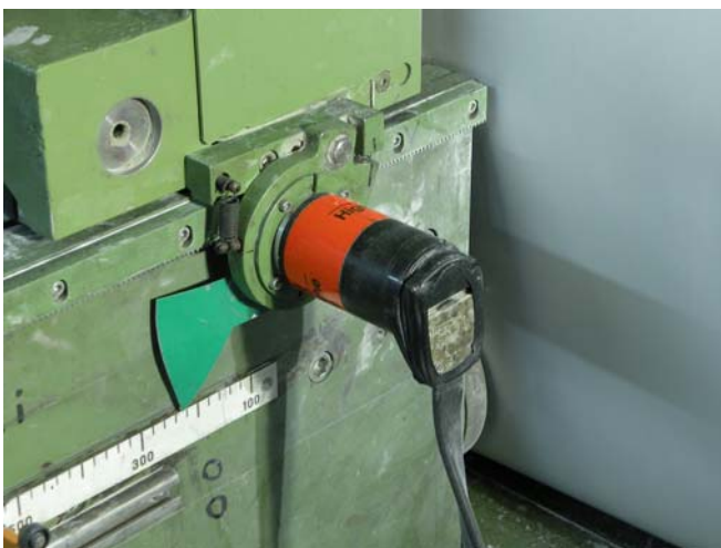
PRIMA E DOPO LA SOSTITUZIONE DEGLI ENCODER TWK CON QUELLI ELTRA APPOSITAMENTE REALIZZATI NEL 2002
