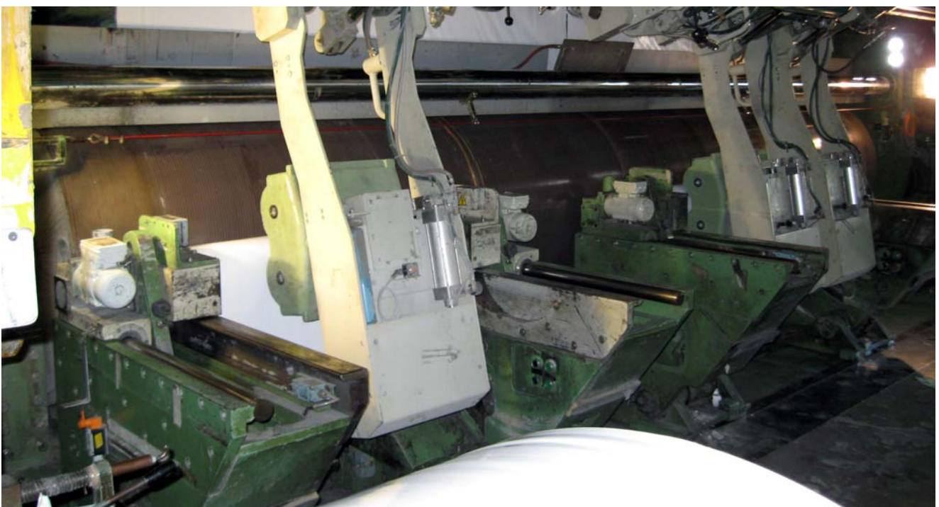
VEDUTA DEL TAMBURO AVVOLGENTE CON PRESSORI INSERITI, SAEL Intelligent Drive
